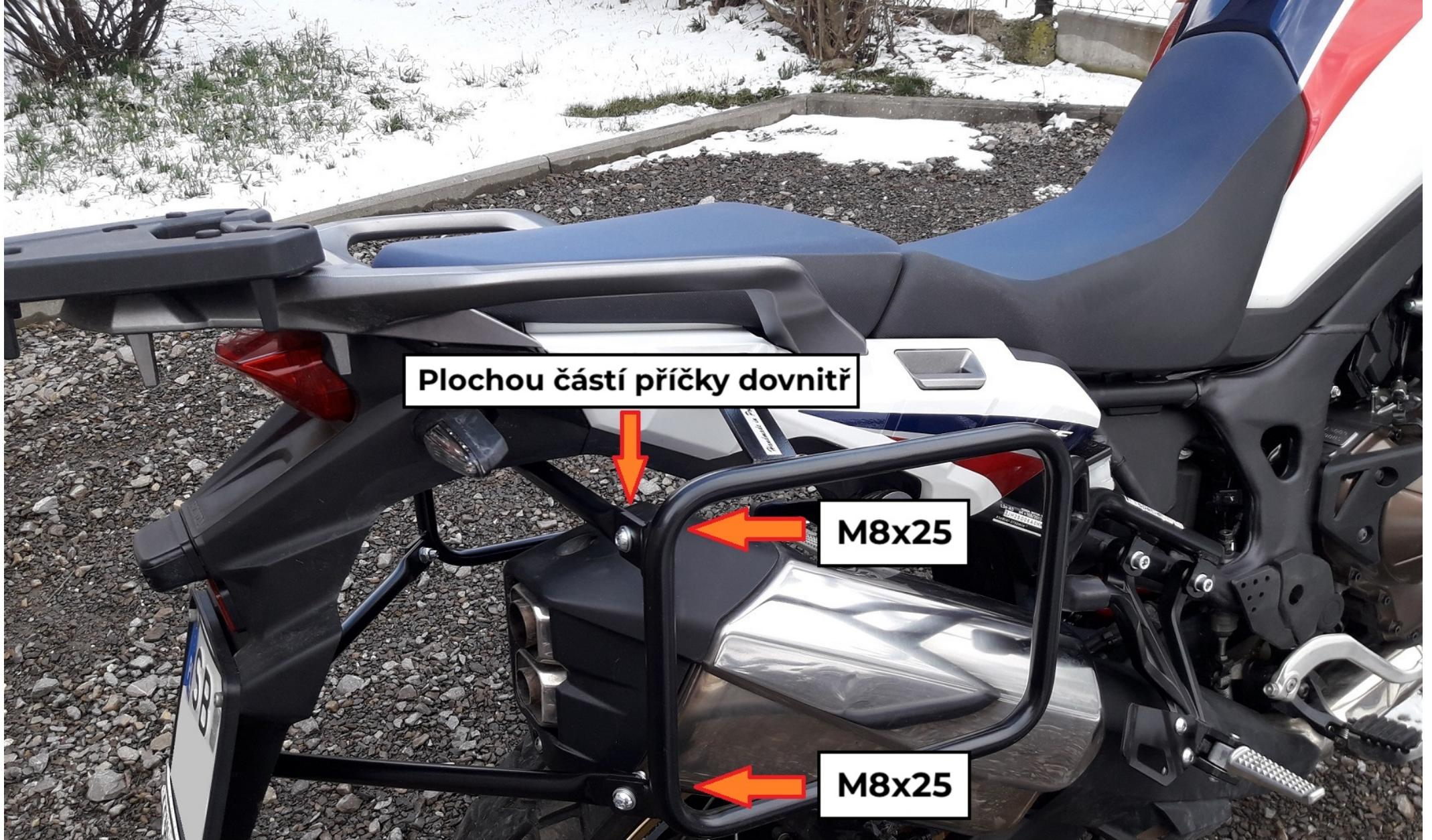
Nosič přišroubujeme na příčku a zadní spojku pomocí šroubu M8x25 se samojistnými matkami. Ploché části příčky i zadní spojky jsou na vnitřní straně - blíže k motorce. Po smontování všech částí dohromady dotáhneme všechny šrouby.
