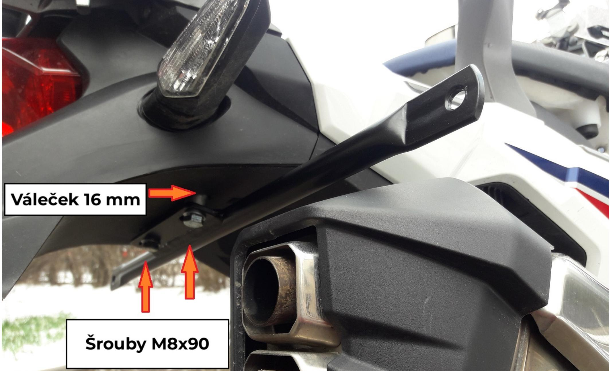
**Po vyvrtání otvorů v blatníku namontujeme příčku na kterou budou přichyceny boční části nosičů.**
